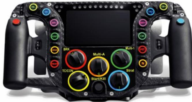
Abruf Zusatzleistung zum Überholen: In diesem Knopf manifestiert sich die Faszination des Antriebs. Das Zauberwort heißt Boost. Wenn der Fahrer den roten Knopf oben links am Lenkrad drückt, ruft er die elektrische Energie ab, die der Porsche 919 Hybrid in seinen flüssigkeitsgekühlten Lithium-Ionen-Batterien gehortet hat. Es geht um furchterregende mehrere Hundert PS, die plötzlich zupacken, den Piloten in die Sitzschale pressen und den Prototyp in einen Allradler verwandeln.
