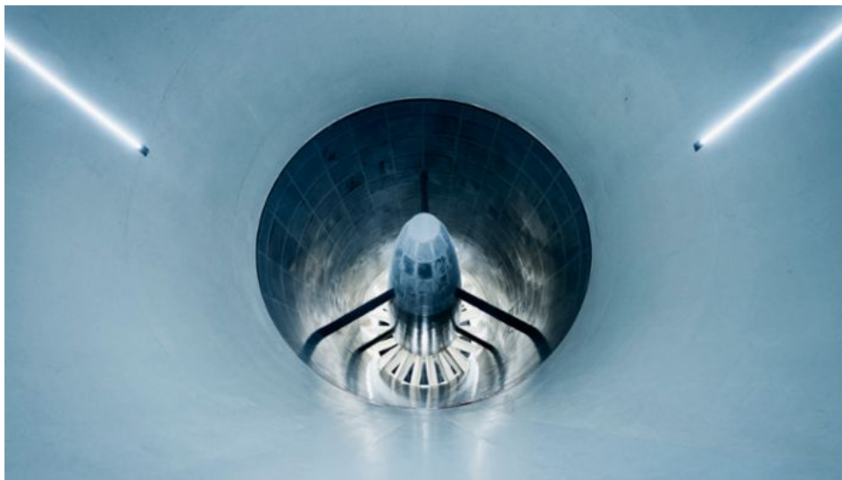
Der Gebläsemotor hat eine Antriebsleistung von 7000 kW.
