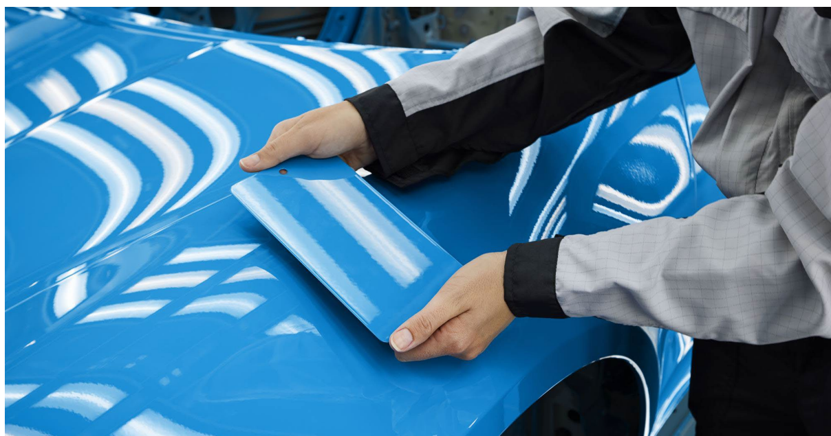
Atelier de peinture Porsche à Zuffenhausen : des plaques sont peintes et servent d'échantillons de référence de couleur lors de l'inspection finale du véhicule.
