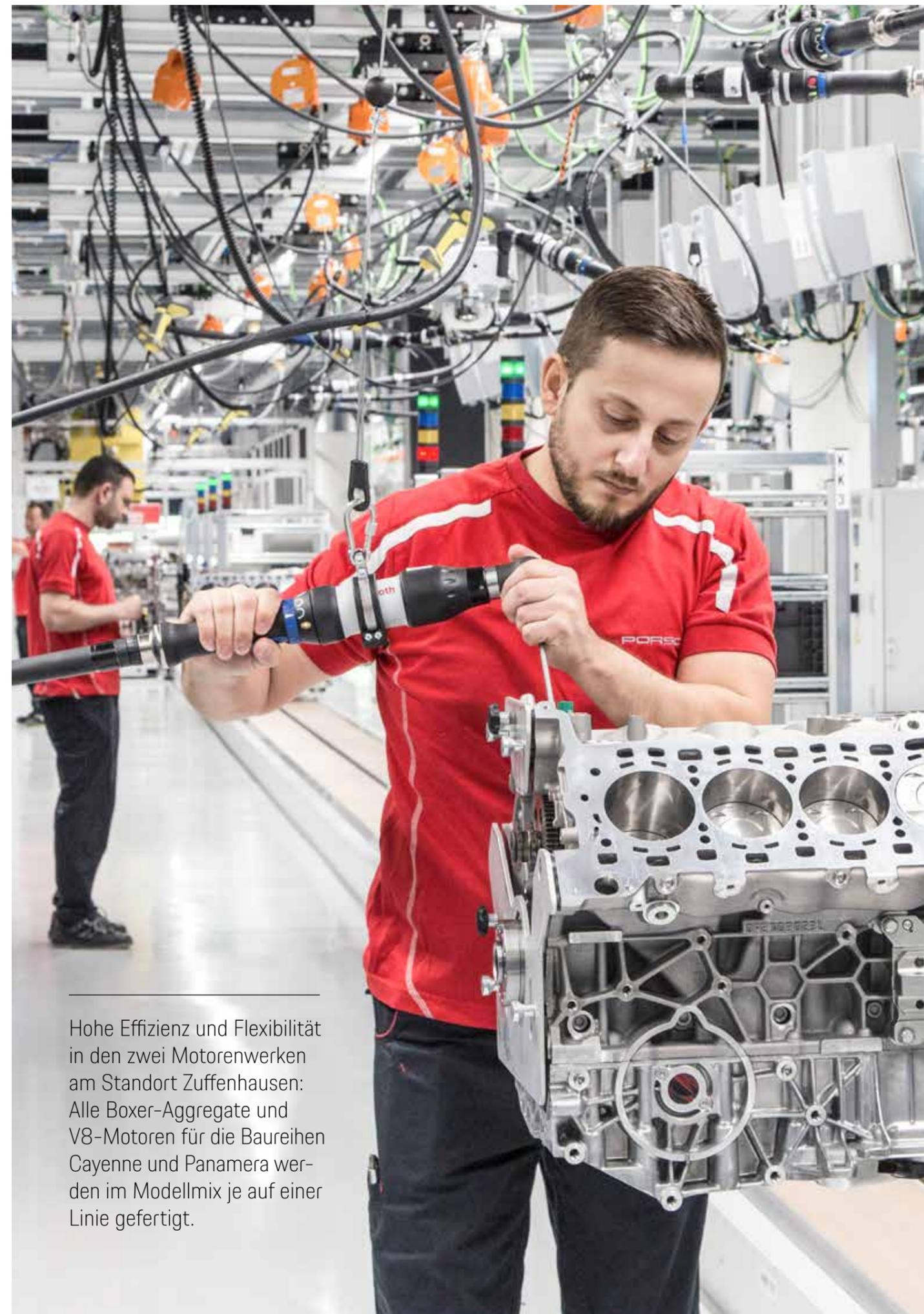
Hohe Effizienz und Flexibilität in den zwei Motorenwerken am Standort Zuffenhausen: Alle Boxer-Aggregate und V8-Motoren für die Baureihen Cayenne und Panamera werden im Modellmix je auf einer Linie gefertigt.
