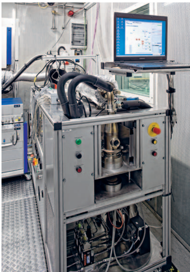
ADA-Prüfstand zur Überprüfung des Schadstoffausstoßes
