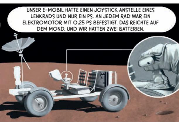
UNSER E-MOBIL HATTE EINEN JOYSTICK ANSTELLE EINES LENKRADS UND NUR EIN PS. AN JEDEM RAD WAR EIN ELEKTROMOTOR MIT 0,25 PS BEFESTIGT. DAS REICHTE AUF DEM MOND. UND WIR HATTEN ZWEI BATTERIEN.
