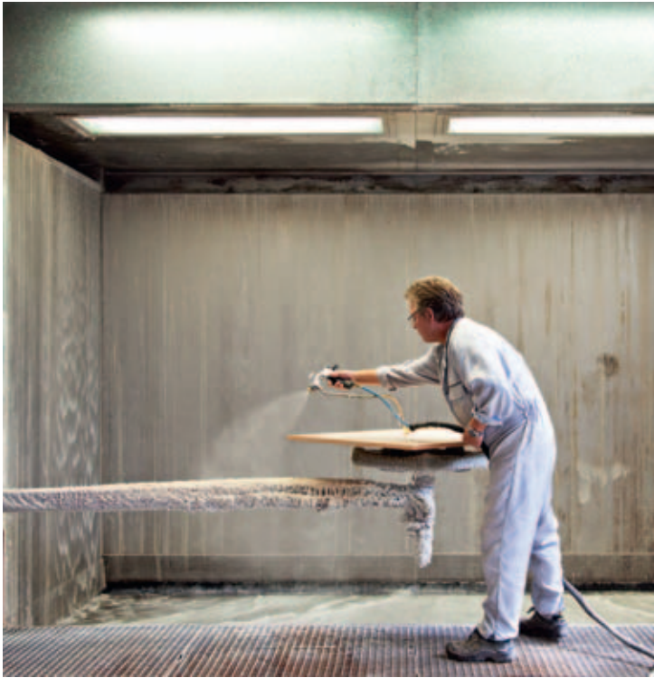
Handarbeit made in Germany: In den Fertigungsstätten in Arnberg werden alle Holzplatten für die Möbelproduktion mittels Spritzpistole und Druckluft von Hand lackiert, um höchste Qualität zu garantieren. Dämpfe der wasserlöslichen Lacke werden sofort abgesaugt.
