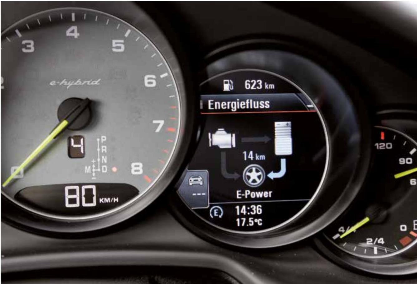
„Power-Meter“: Es stellt jeden Fahrzustand übersichtlich dar. Der „E-Power“-Modus ermöglicht 135 km/h Höchstgeschwindigkeit – und der Drehzahlmesser bleibt auf Null.
